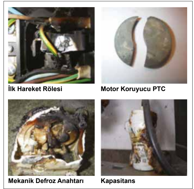
Şekil 1. Buzdolabı yangınlarına neden olan bazı kaynaklar [4].
